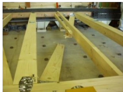
筋かいの破損
